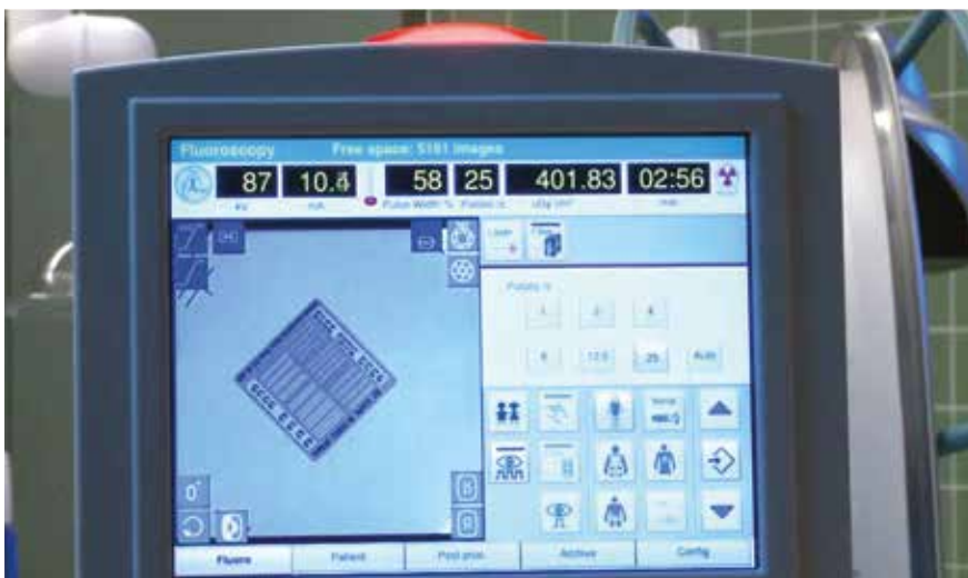
Kuvanlaadun havainnollistaminen c-kaaren eri toiminnoilla testikappaleen avulla.
